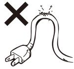
電源コードを傷つけたり、破損したり、加工したり、無理に曲げたり、引っ張ったり、ねじったり、たばねたりしないでください。また、重い物を載せたり、挟み込んだり、加工したりしないでください。
