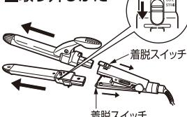
本体を閉じ、上下の着脱スイッチを矢印の方向に引いた状態でパイプを片方ずつ差し込む。
