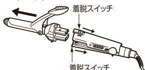
本体を閉じ、上下の着脱スイッチを矢印の方向に引いた状態でパイプを差し込む。
